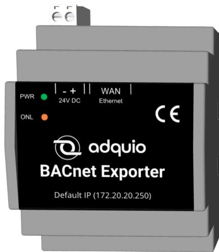
Adquio BACnet Exporter es un dispositivo diseñado para trabajar junto con cualquiera de los controladores del ecosistema Adquio, por lo tanto, lo puedes usar acompañando a un Adquio Mini, Lite, Microserver o un Adquio Server e incluso un Adquio Link.
